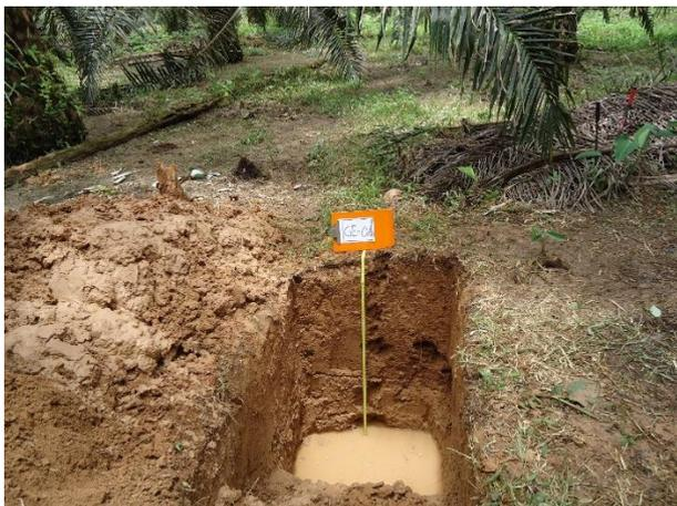
Foto 18. Calicata con afloramiento de la napa freática a 1.36 m de profundidad, entre capa conglomerádica de clastos finos a medios en matriz limo-arcillosa, en relieve de terraza media, en el piedemonte andino. UTM: 431,572 E / 9'005,046, 339 msnm.
