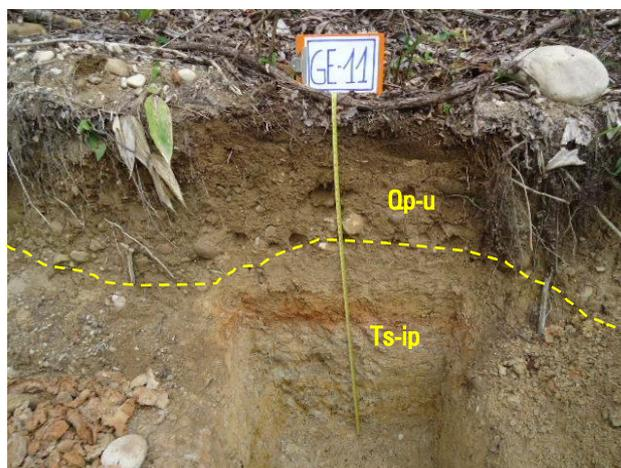
Foto 5. Contacto entre Formación Ipururo (con arcillitas ferruginosas y Formación Ucayali (conglomerados), UTM: 437,656 E / 9'008,622 N, 344 msnm.
