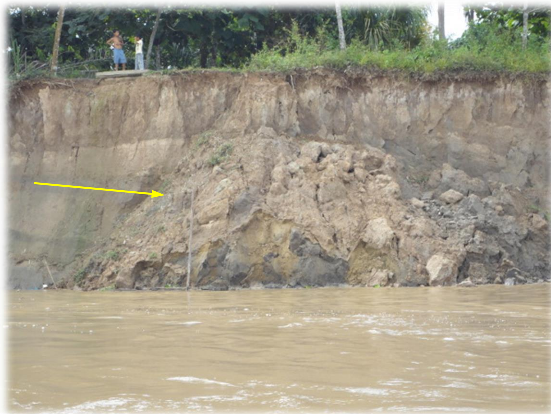
Foto N° 23: Deslizamiento de materiales cuaternarios y terciarios, producido por humedecimiento y erosión lateral, margen izquierda del río Amazonas, a 10 metros de la Foto 22 aguas abajo de la foto anterior.
