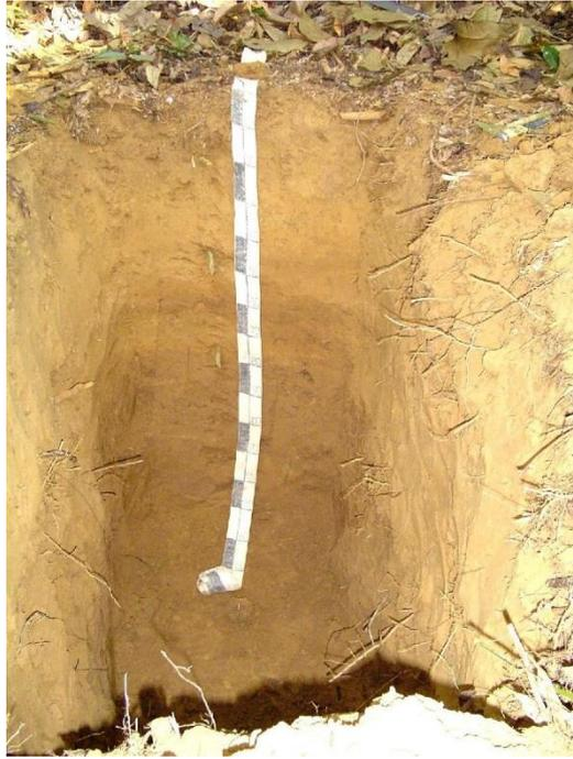
Foto N°4 Perfil edáfico de la serie Dique, ubicado en las terrazas bajas con buen drenaje, de textura arenosa
