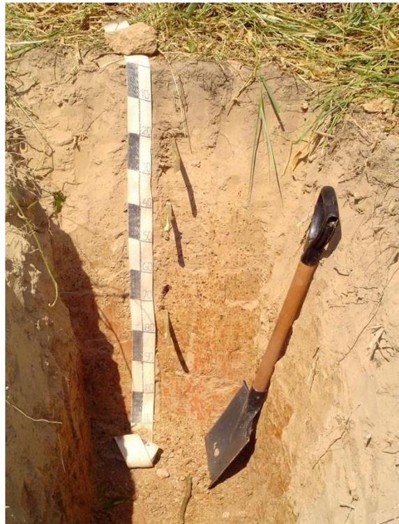
Foto N° 6 Perfil edáfico de la serie Alerta obsérvese las concreciones ferromagnesianas como puntos, de color oscuro en el perfil.
